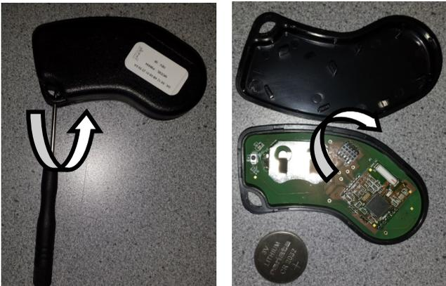
Ecarter les 2 coques avec le tournevis fourni, insérer la pile, la LED clignote rouge.
